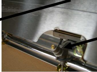
Quitar cada uno de los inyectores del final del cuerpo de la válvula, girando cuidadosamente en sentido contrario a las agujas del reloj. Tenga cuidado de no bloquear el orificio al final de la válvula donde está fijado el inyector de gas y no retirar ninguno de los hilos que componen el sellado del orificio donde está situado el inyector.
