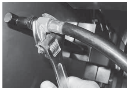
Monte el gas sobre la conexión de tuberías montada previamente o sobre el 1/4 de hilo de enlace (Fig. 7)
